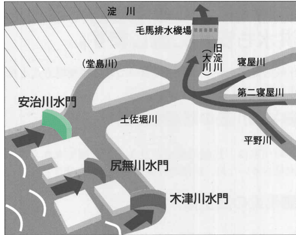
旧淀川筋の防潮水門方式のイメージ図
