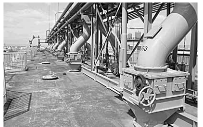
〈写真③〉小麦を搬入・搬出する経路となる設備群(写真上はサイロ屋上、下はサイロ内部)
