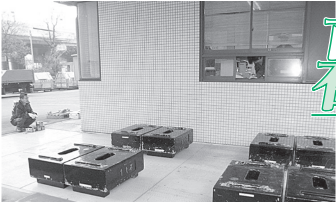
環境局鶴見工場での「定期検査」(手前は鉄板状の「はかり」とその上に載せられた巨大な1t分銅。左奥の職員の傍にあるのが10kg分銅など。これらを載せたり降ろしたりして「はかり」の正確さを調べる)
